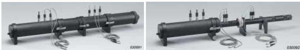
Şekil 2. Ses iletim kaybının frekansa bağlı olarak belirlenmesi amacıyla kullanılan ölçüm sistemi.
